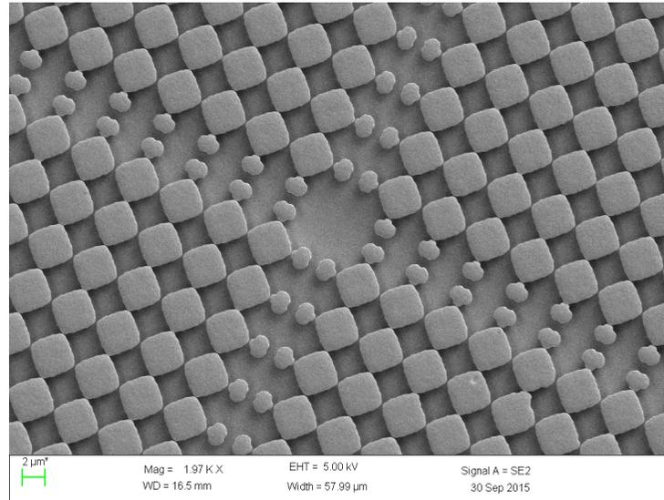
*Masque d'amplitude et Réseau de diffraction pour analyse de surface d'onde en Rayons X (P. Mercère et al., SOLEIL)*
