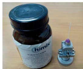
Figure 2 : Echantillon de paracétamol introduit dans un capillaire de 0,7mm monté sur une tête goniométrique.
