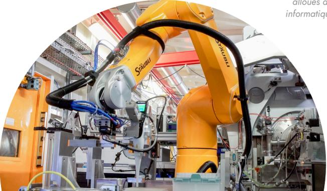
Fiabilisation, par automatisation, des opérations de micro-pipetage sur la ligne de lumière SWING.
