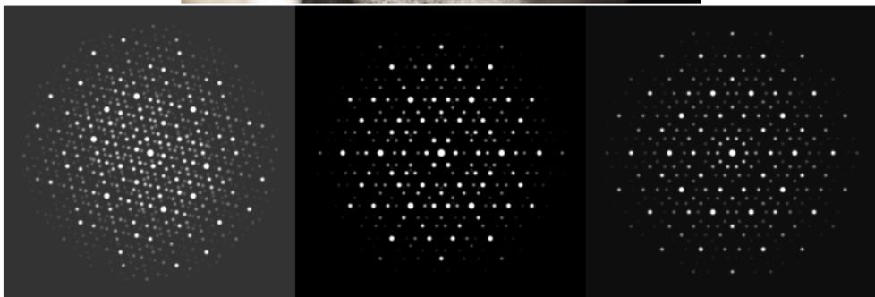
Diagrammes de diffraction des phases icosaédriques F MgZnCe selon les directions 2, 3 et 5.
