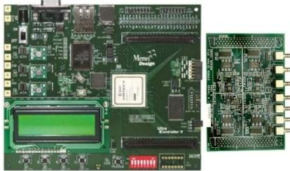
Memec Virtex-4 FX12 LC + P160 analog module
